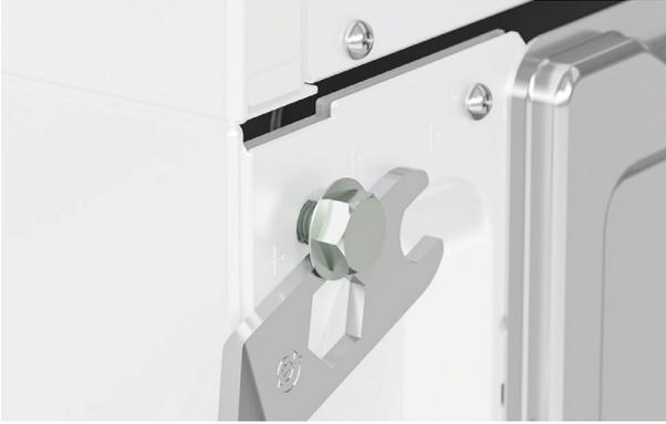
4. 使用随附的呆扳手作为垫板，确保螺栓头和机壳之间留有 4mm 的间隙。
