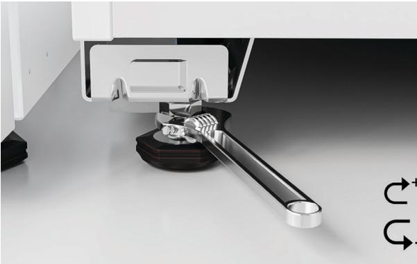
8. 当机柜处于最终位置时，使用随附的呆扳手拧下前调平支脚。重新检查间隙和对齐情况，再将锁定螺母向上紧固到机柜底面，从而将支脚锁定到位。
