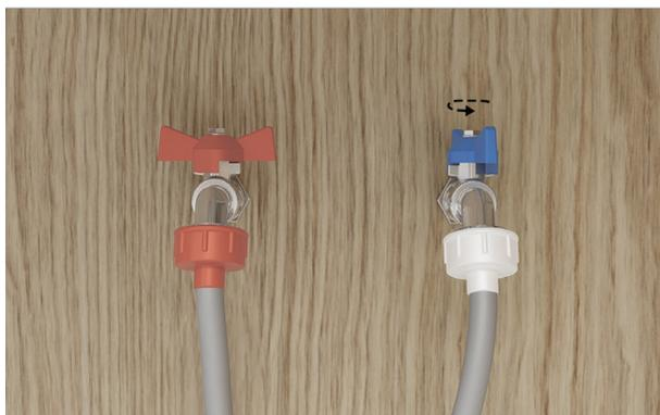
15. 开机前将软管连接到水龙头。
