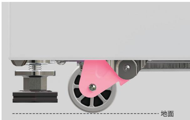
2. 在将底座滚动到最终安装位置之前，确保所有支脚都已抬高离地面。
