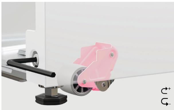
1. 将叠装的产品部分推入安装柜并检查对齐情况。为此，请使用随附的 6mm 内六角扳手，顺时针旋转，通过调节螺丝降低两组轮子。
