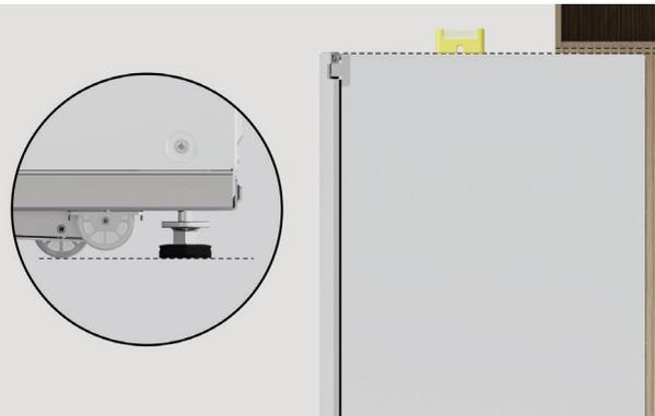
3. 将后支脚调整到所需高度，然后安装到安装柜。
