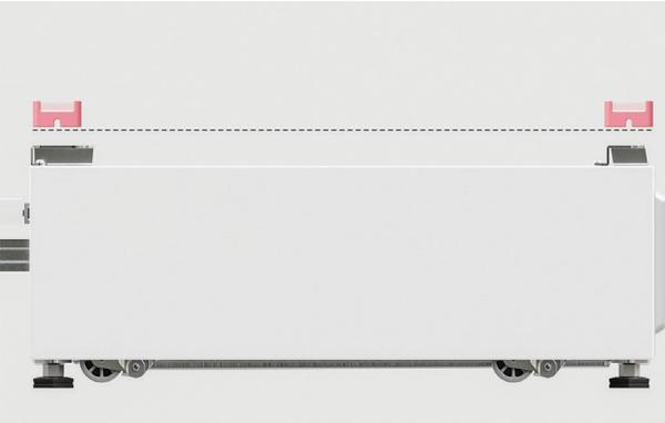
2. 将底座放在最终安装位置。使用供应的呆扳手调整支脚，直到洗衣机从前到后、从角到角保持水平。
