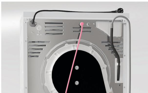
4. 从洗衣机和干机上取下盖子，然后安装一根通信电缆。通过通信电缆连接洗衣机和干衣机。
