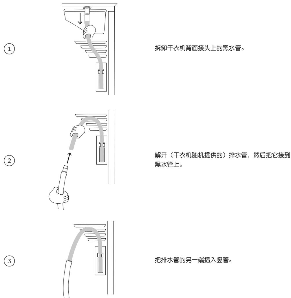
拆卸干衣机背面接头上的黑水管。
