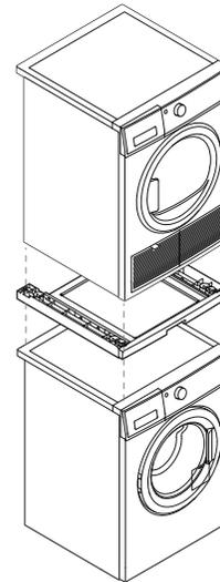
**必须在洗衣机和干衣机之间使用叠装套件，并根据叠装套件安装说明把它正确安装在洗衣机和干衣机上。**
