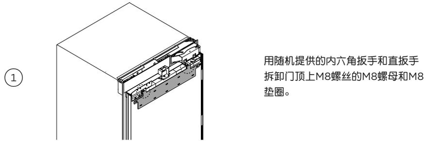
用随机提供的内六角扳手和直扳手拆卸门顶上M8螺丝的M8螺母和M8垫圈。
