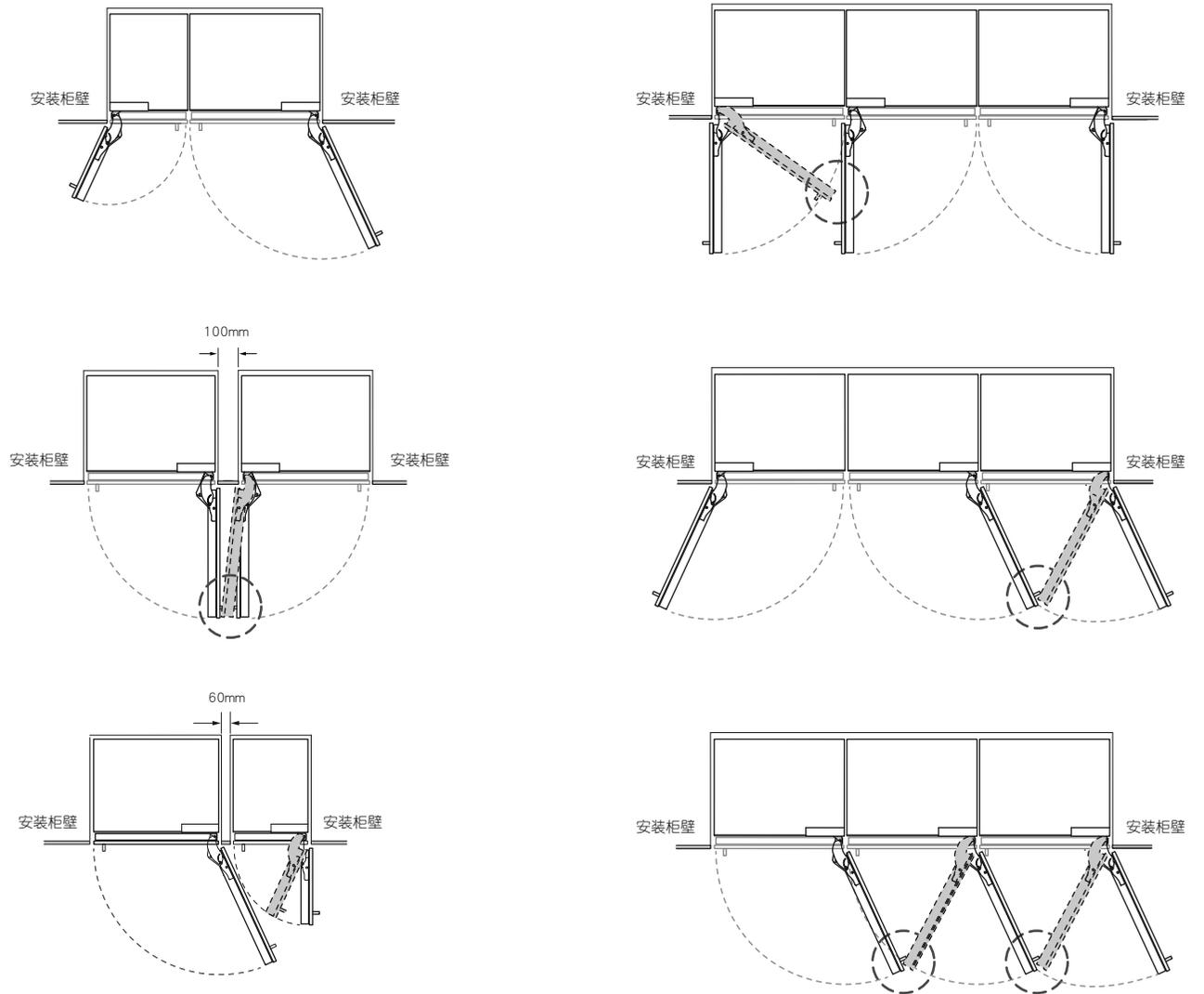
上述插图说明不同安装方式的开门幅度和隔板（可选）。切记在同时开门时，门或手柄会发生碰撞（画圈部分）。
