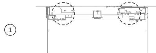
用8Gx16沉头螺丝把左右两边的上支架固定在安装柜顶上。
