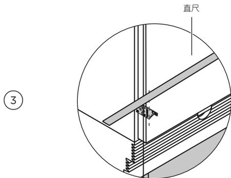
在调节螺丝时检查校准规，确保电器始终与安装柜齐平。
