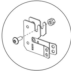
用随机提供的M6螺丝和螺母把两个下支架固定在一起。用4mm内六角扳手和10mm扳手拧紧螺母。
