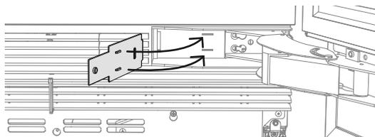
把铰链槽板盖放在铰链槽板上，让盖子上的加强筋对准铰链槽板上的凹槽。
