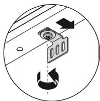
松开门底面的螺丝，然后滑出联锁托架，直到它接触门板。
