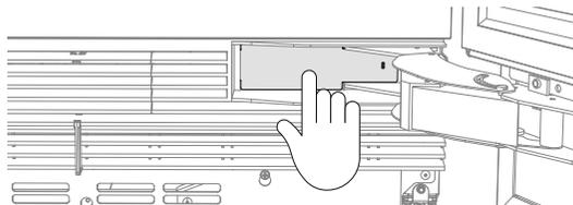
压铰链槽板盖使其卡进铰链槽板。
