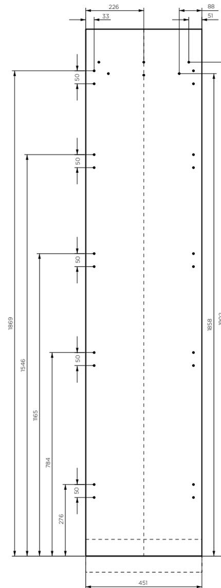
建议钻18个导孔安装支架。
