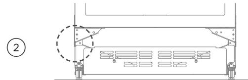
用8Gx16沉头螺丝把一个下侧面支架固定在安装柜侧壁上。
