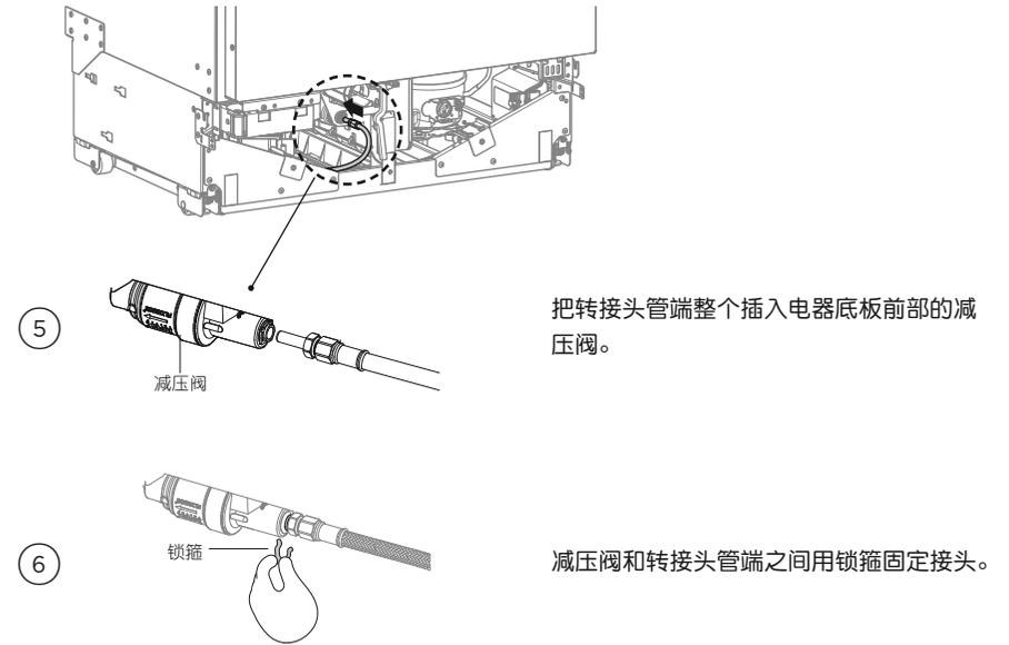
把转接头管端整个插入电器底板前部的减压阀。
