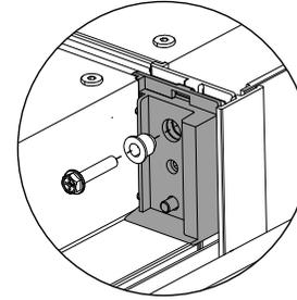
用随机提供的第一个M5螺栓和接头套把两个上支架固定在一起。用8mm套筒板手和十字螺丝刀拧紧接头套，直到接头套与支架表面齐平。
