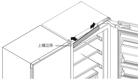
把上镶边条的一端滑进此电器的铰链槽板。
