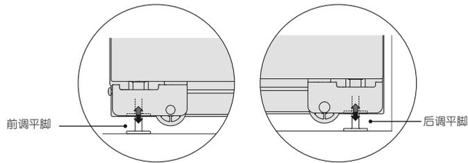
顺时针旋转前后调节螺丝伸出前脚和后脚，直到前后脚接触地面、顶面安装支架接触安装柜顶。
