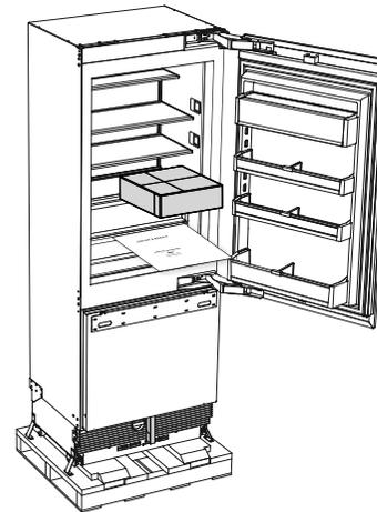
取出电器里的安装套件和其他零部件。
