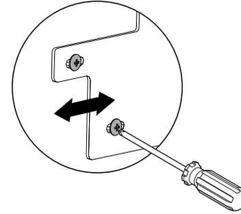
如要进一步调节门板，松开M8螺母和垫圈，然后根据需要滑动门板。如还要进一步调节门板，先拆卸门板，然后松开吊架固定螺丝并根据需要向一侧移动吊架。
