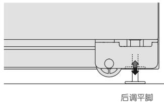
先从外面的调平脚开始调节，转动右边的螺丝调节电器后部，然后转动左边的螺丝调节电器前部。在把电器推进安装柜之后，调节中间调平脚。
