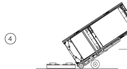
让电器稍稍后倾落在手推车上，然后收好托板。
