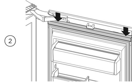
② 向下压上盖板两端，让镶边条盖贴合在双面胶上。
