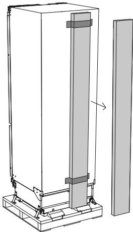
取下电器背面的镶边条。参看**随机提供的零部件 — 镶边条安装套件**部分了解包装箱里的零部件
