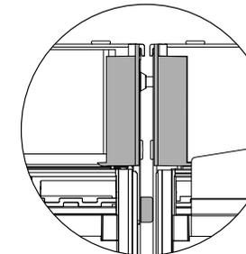
确保法兰接头如图所示接触两台相邻电器。
