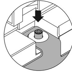
握住门板使其与门顶成一定角度，然后放低吊架螺孔使其落在调节螺丝上。
