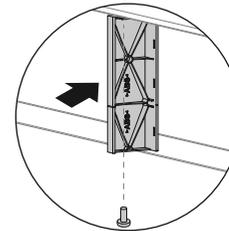
用力按压气流隔板使其贴合在门板/抽屉面板底部。
