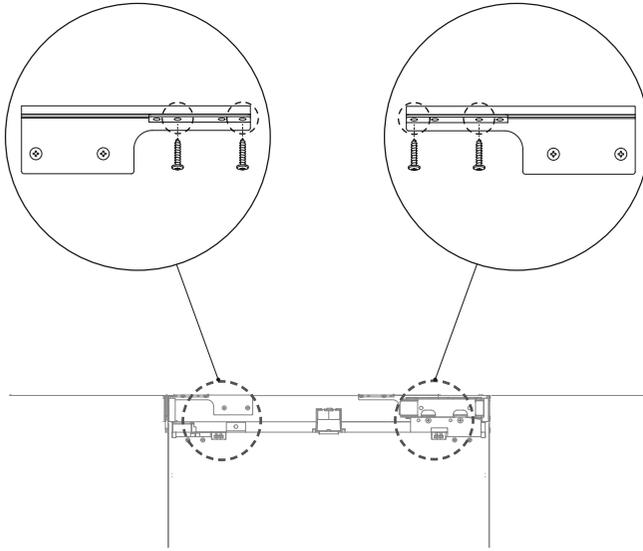
用8Gx16沉头螺丝把上支架固定在安装柜顶上。
