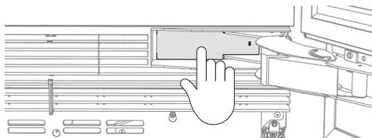
压铰链槽板盖使其卡进铰链槽板。
