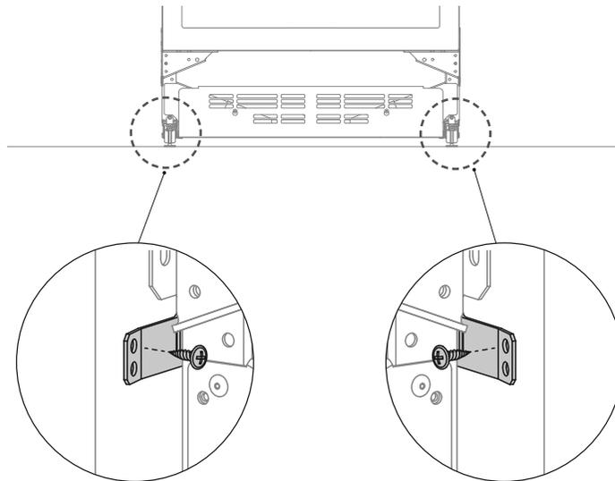
用8Gx16沉头螺丝把2个侧面支架固定在安装柜左右两边的下半部。
