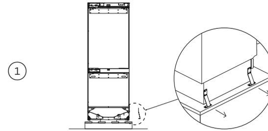
拆卸托板无铰链侧的支架。
