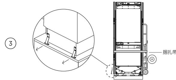
用捆扎带固定电器，然后拆卸其余支架。利用角柱捆扎固定电器，避免挤压侧面镶边条。
