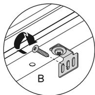
用8Gx16沉头螺丝把联锁托架固定在门板上。
