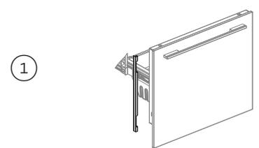
① 把抽屉侧面盖板插入抽屉左右两边的面板间隙里。
