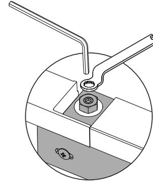
在调节好门板位置之后，拧紧调节螺丝上的M8垫圈和螺母。
