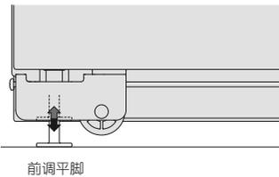
确保调平脚接触底板，上支架接触槽板。
