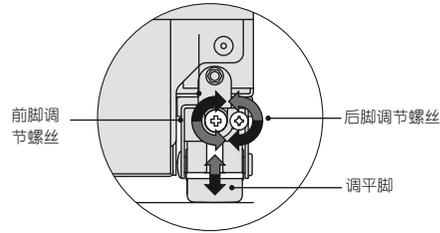
顺时针旋转前后调节螺丝调高电器高度。
