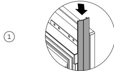
① 把门侧面盖板插入抽屉左右两边的间隙里并向下滑到卡紧。用力按压贴紧。
