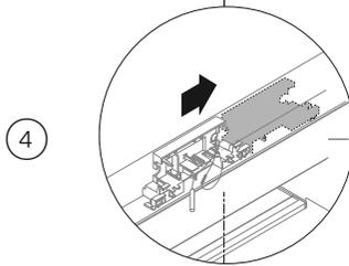
④ 移动传感器盒，使相对的霍尔传感器夹对准安装柜中心。
