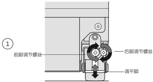
顺时针转动前后调节螺丝升高电器高度，反时针转动调节螺丝降低电器高度。
