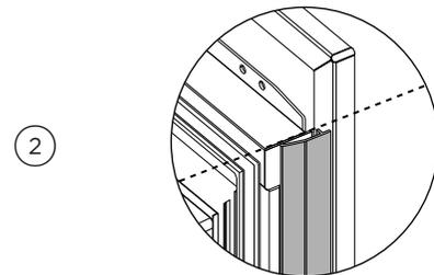
② 确保侧面盖板顶部对准上门板扣件。
