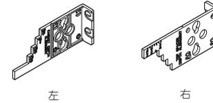
把螺丝插入校准规锁眼确定校准规位置。
