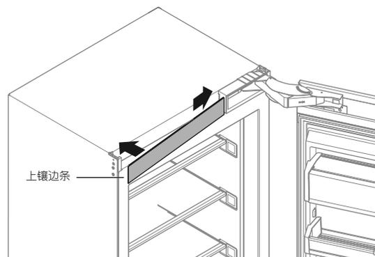
把上镶边条的一端滑进此电器的铰链槽板。
