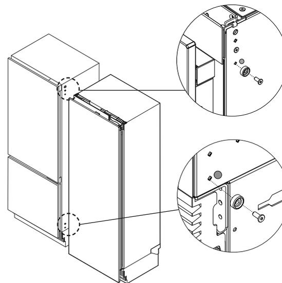
拆卸电器上绿色标签所在位置的螺栓。安装法兰接头，然后用3mm内六角扳手拧紧法兰接头。
