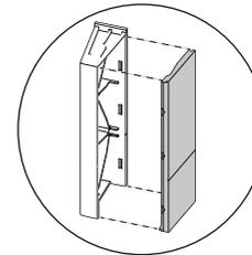
把气流隔板盖安装在气流隔板上。
