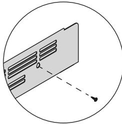
用此前拆卸的螺丝把踢脚板安装板重新安装在底座上。
