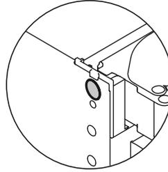
在把此电器推进安装柜之前，先把棘螺丝插入电器左右两侧顶部的大孔里。
