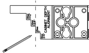
根据门板厚度，利用深度校准规的**安装柜深度校准**一侧的模板在门两边画出台阶。
