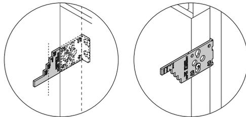
在调节螺丝时检查校准规，确保电器始终与安装柜齐平。
