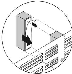
如果踢脚板深度小于92mm，在安装板上贴一块踢脚板密封条。
