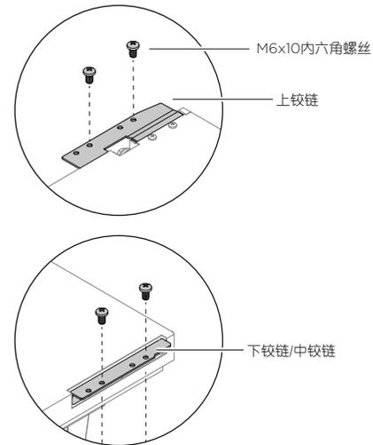
拆卸上铰链和下铰链/中铰链上的门铰链M6x10内六角螺丝取下电器门。
