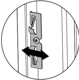
松开侧面支架上的侧面螺丝，然后前后滑动门板。
