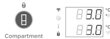
在安装完毕之后，打开控制面板锁，然后按住**储存室按钮** 四秒钟开始制冷。
