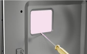
取下玻璃灯罩。把小平头螺丝刀插进灯罩和烤箱侧壁之间的凹槽撬开灯罩。
