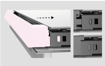
重新安装玻璃固定板，确保玻璃固定板卡到位。
