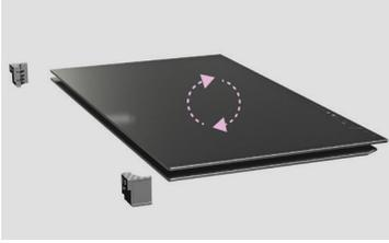
确保在重新安装玻璃板时让玻璃板正确的一面朝上。
