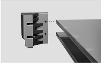
确保橡胶止动块卡在玻璃板上的正确位置。
