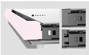
往里推门两边玻璃固定板上的锁片。向上拉玻璃固定板，直到锁片进入最上面的锁孔。
