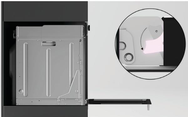
3. 向下推每个锁杆锁住门。确保两边的铰链都锁到位，然后再关门。
