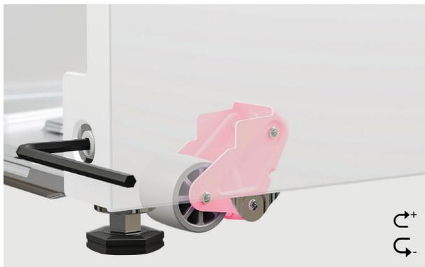
2. 将叠放的产品部分推入安装柜并检查对齐情况。为此，请使用随附的 6mm 内六角扳手，顺时针旋转，通过调节螺丝降低两组轮子。
