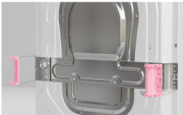
3. 使用十字螺丝刀拆下两个侧面支架。
