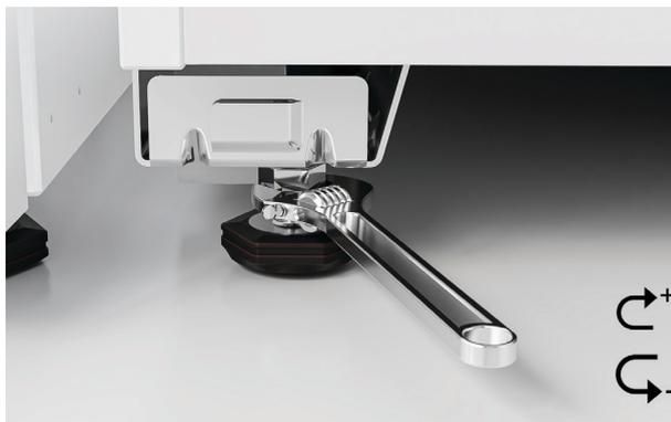
8. 当护理柜处于最终位置时，使用随附的呆扳手拧下前调平支脚。重新检查间隙和对齐情况，再将锁定螺母拧紧到柜底部，从而将支脚锁定到位。
