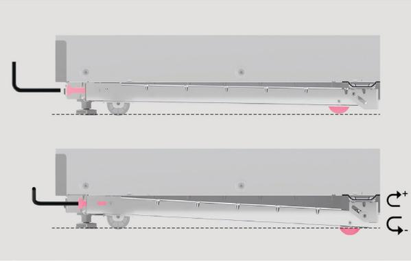
1. 使用随附的内六角扳手打开柜门并降低后轮。
