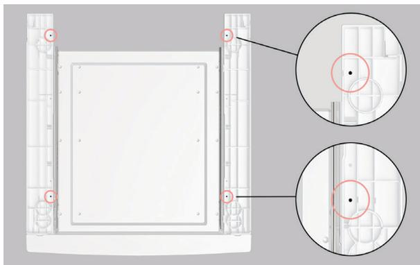
2. 在标记位置使用四个随附的短螺丝将叠放套件固定到洗衣机上。如果使用钻头，建议使用最低扭矩设置。
