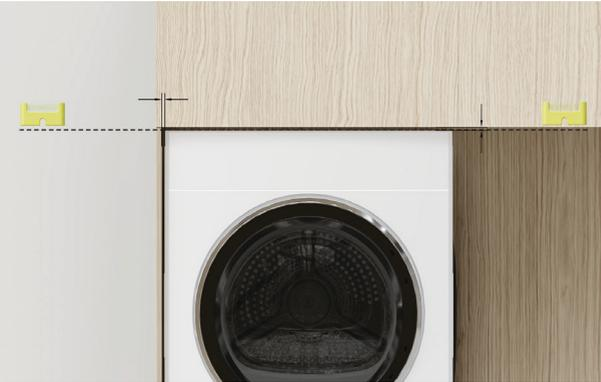
19. 检查对齐情况，确保所需的间隙。根据需要进行调整。
