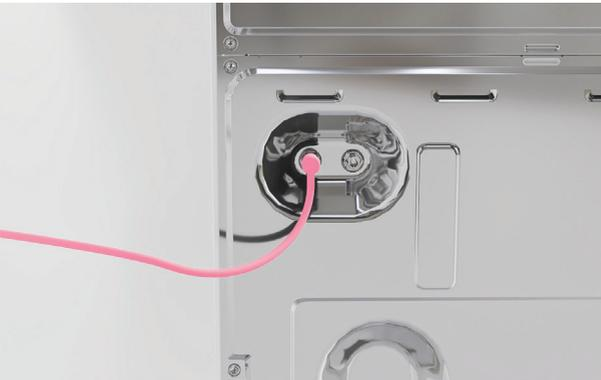
6. 连接通信电缆和电源线。
