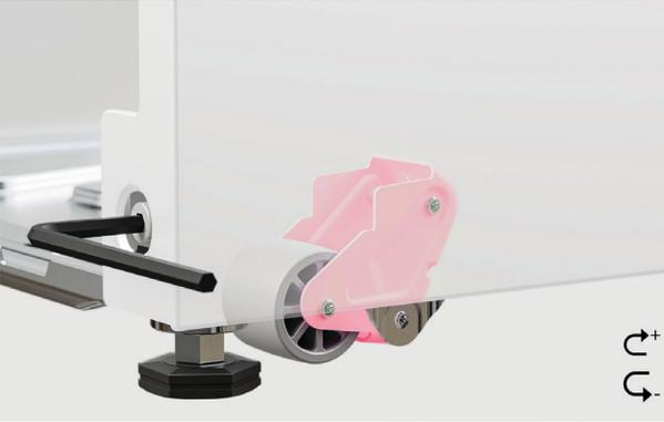
4. 使用随附的 6mm 内六角扳手，逆时针旋转，通过调节螺丝升起两组轮。
