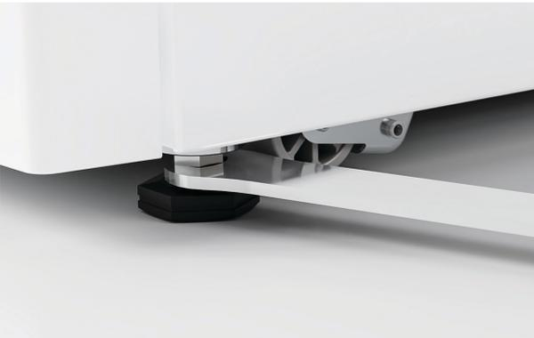
3. 使用随附的呆扳手，将锁定螺母拧紧到底座基部，将支脚锁定到位。
